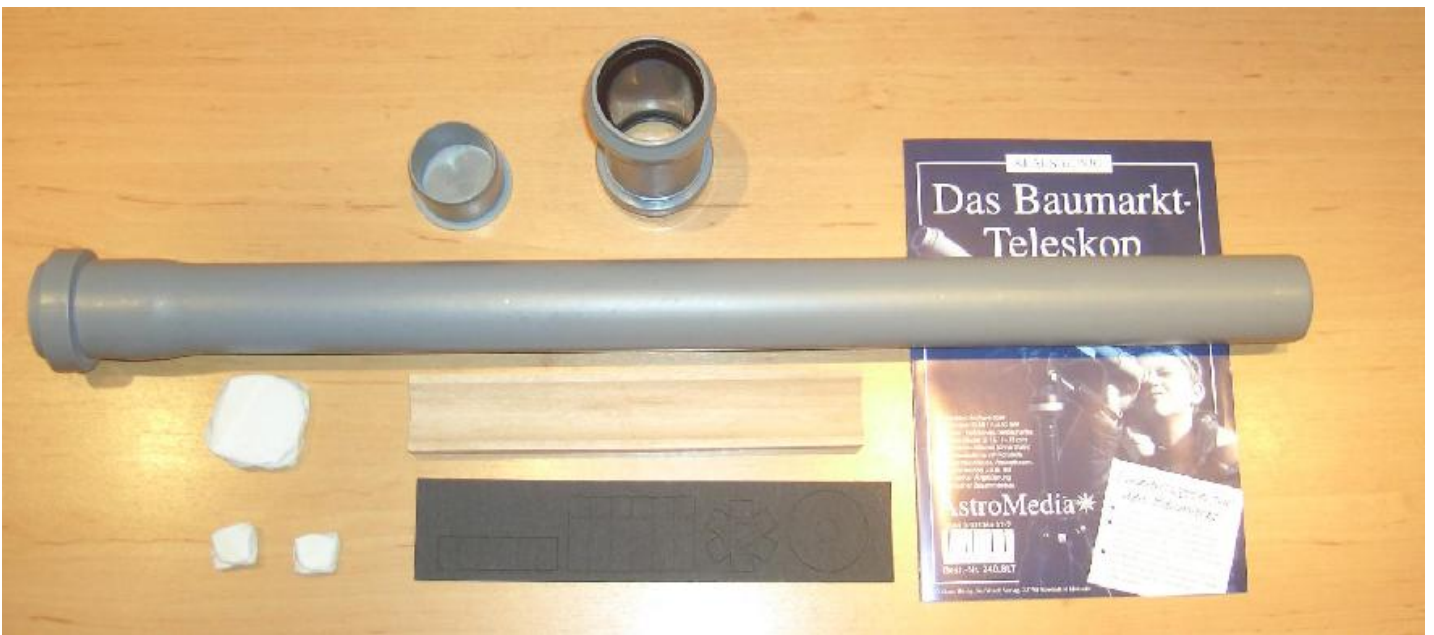
Einzelteile des Bausatzes sowie weiteres Material (drei Rohrteile aus dem Baumarkt)
