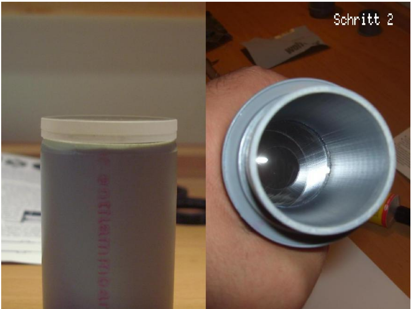
Die Befestigung der Objektivlinse erfolgte im Gegensatz zur Anleitung mittels einiger Kleinstropfen Cyanacrylat.
