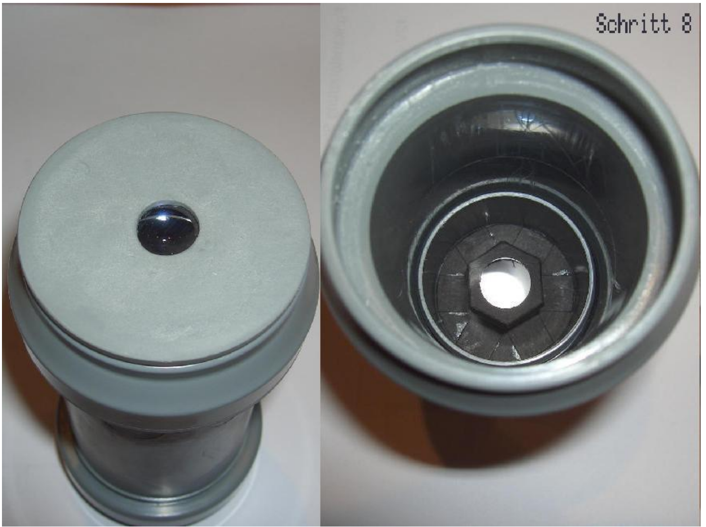
Fertig zusammengesetzter Okulartubus, Innen- und Aussenansicht
