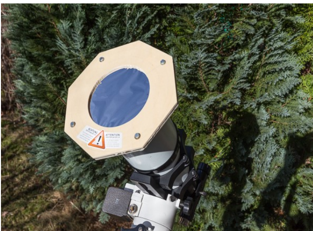
Bild 1: Selbstbaufilter aus AstroSolarFolie, © Thomas Wolf
