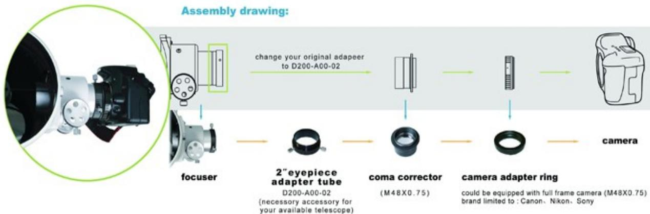
**Anschlußschema für Skywatcher Newton und dem F5 Coma-Corrector von SW**
