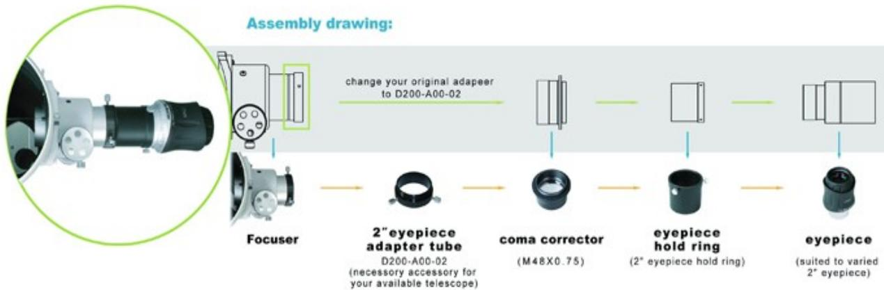
**coma corrector + camera**
